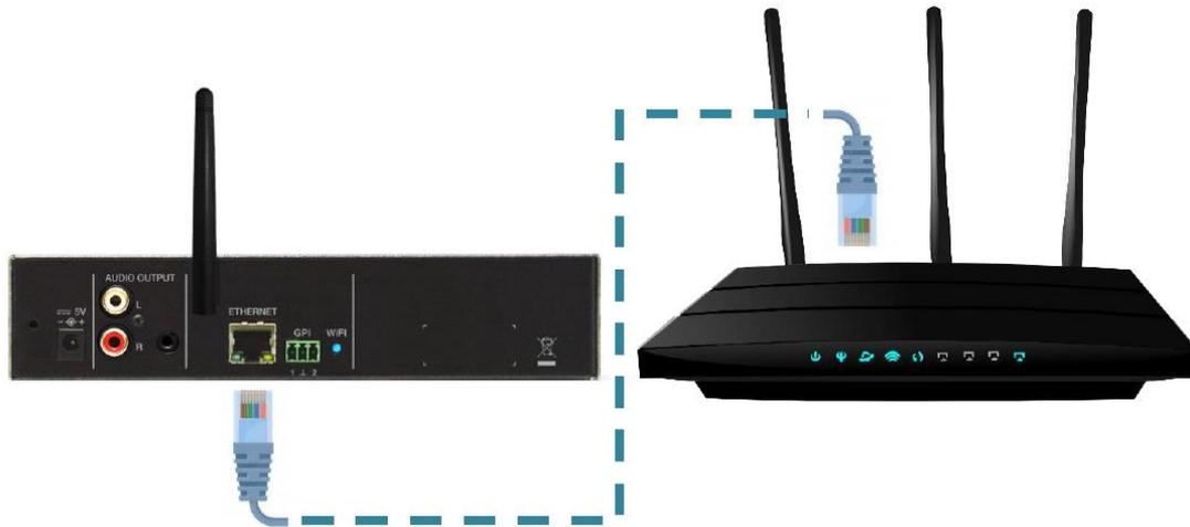
Figura 5 : ejemplo de conexionado a través de la interfaz de red Ethernet (cable)
