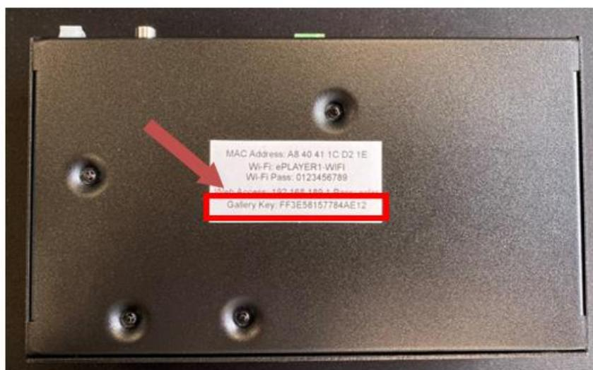
Figura 26: clave de registro en chasis del dispositivo ePLAYER1
