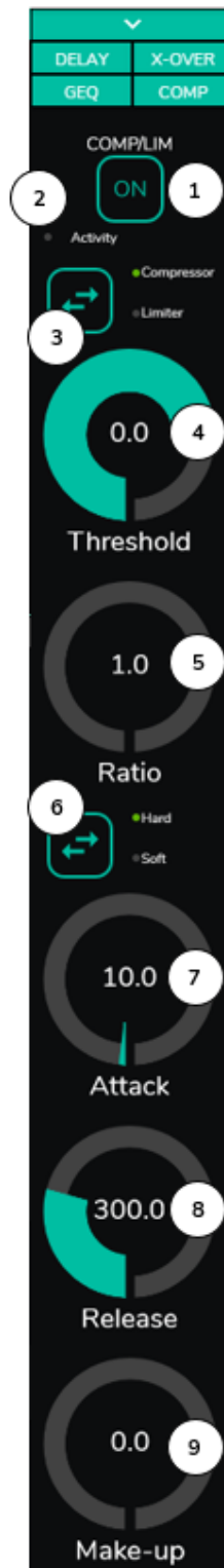
Abbildung 40: Einstellung des Kompressors eines Ausgangs
