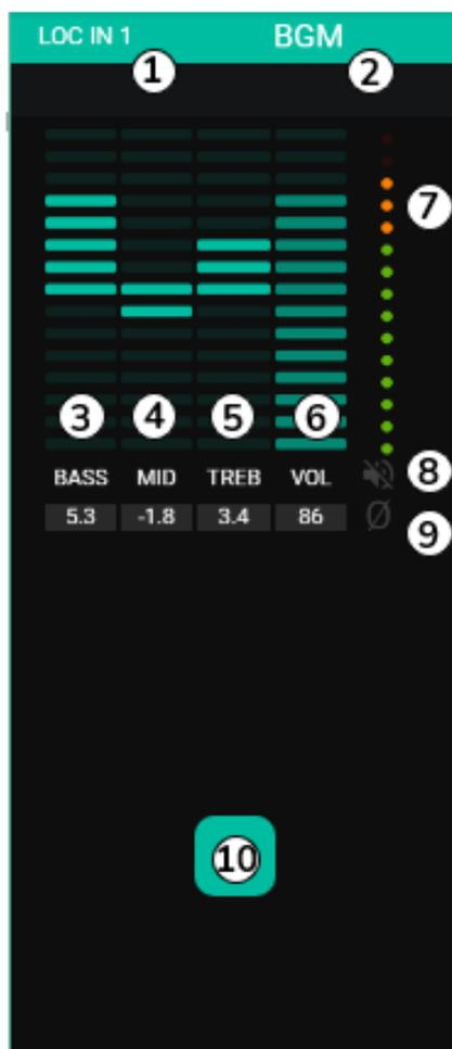
1. Indicateur d'entrée locale, connecteurs de la face arrière (LOC) ou distants (REM), panneaux de télécommande avec entrée audio, plus le numéro lui correspondant.
