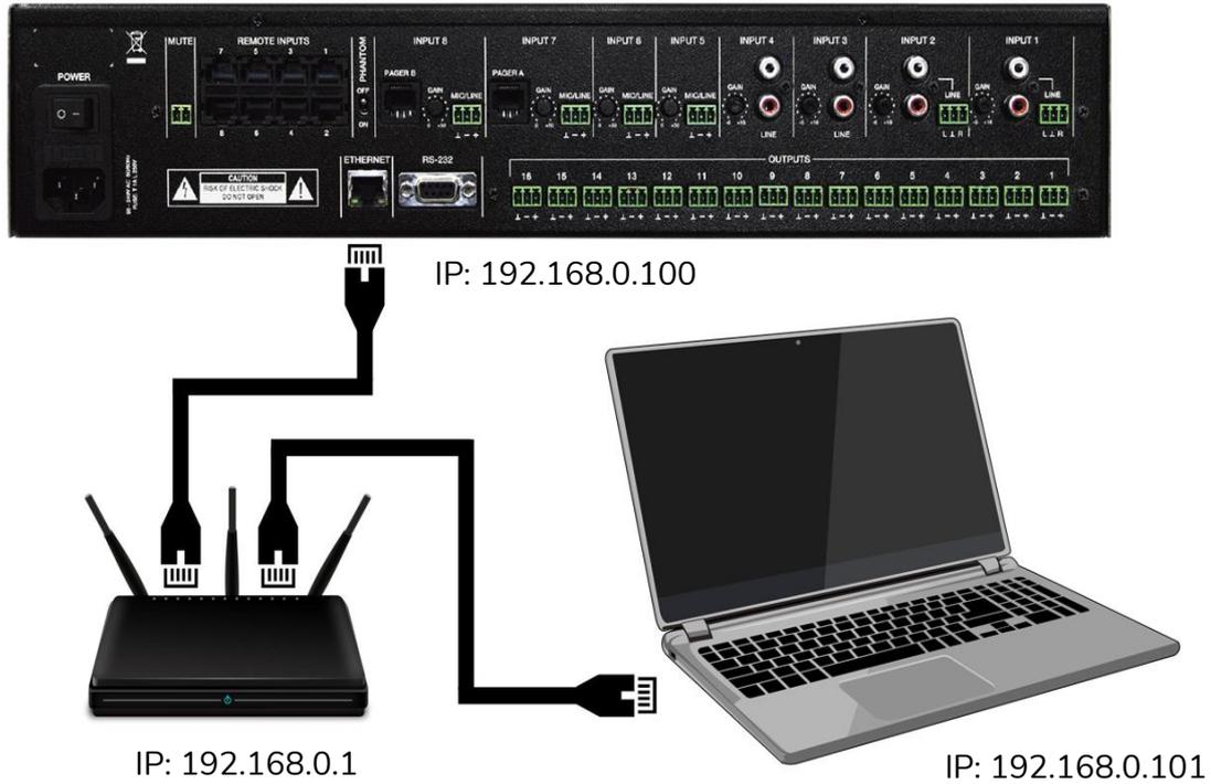
Figure 3 : connexion au réseau local (LAN)
