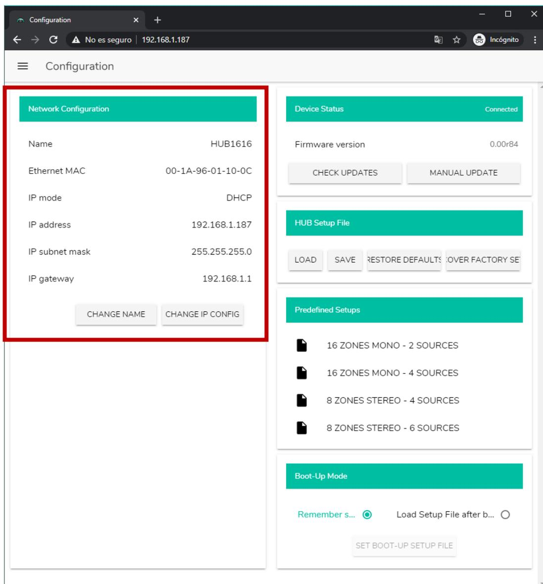
Figure 8 : configuration réseau
