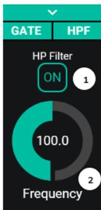
Utile **pour atténuer l'effet de proximité d'un microphone** (augmentation des basses fréquences) **ou éliminer/atténuer le bruit de fond**, les bruits de manipulation, etc. :
