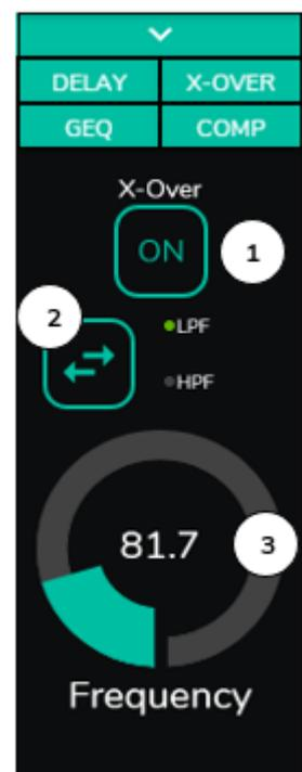
Figure 38 : réglage d'un filtre répartiteur
