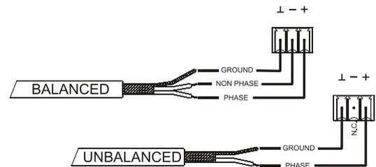
Pour les connexions ASYMÉTRIQUES, ne connectez pas le bornier -.
