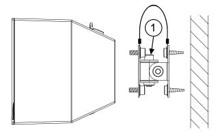
ANMERKUNG: Bitte denken Sie daran, den Sicherheitshaken anzubringen, und dass die mit "1" markierte Schraube oben angebracht wird, damit der Kasten auch bei Lockerung nicht aus der Halterung fällt.
