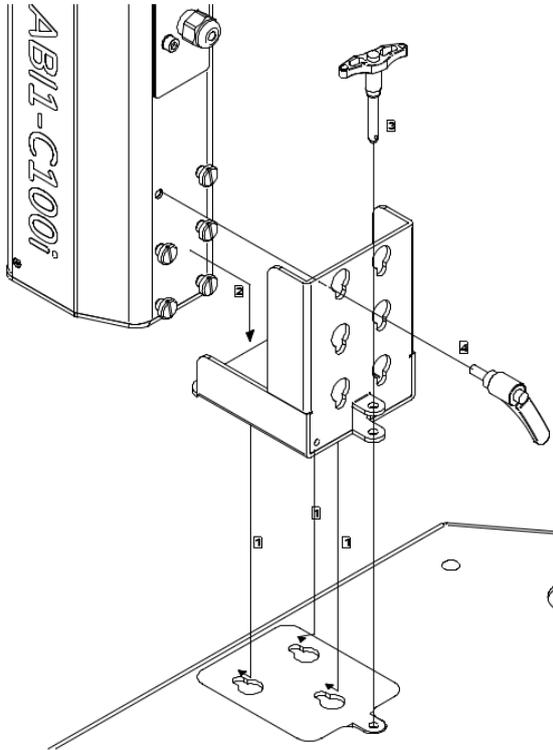
1. Conecte el LABI1-SAC en los orificios de montaje del subwoofer
