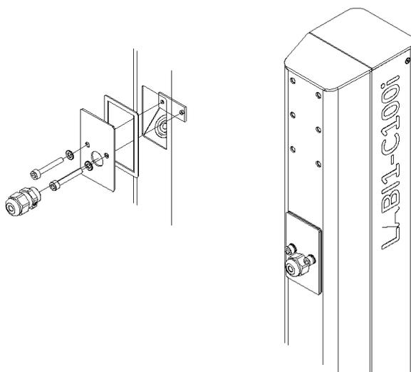
1. Conecte el cable de audio a la columna, y páselo a través del armazón y el agujero redondo del LABI1-ODCNX.
