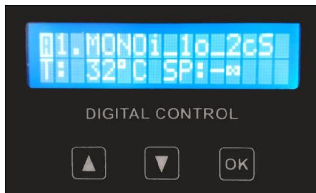
Desde los botones de flecha arriba y abajo es posible seleccionar uno de los 18 presets diferentes. Mantenga pulsado el botón OK hasta que la barra de carga de la pantalla LCD termine, para completar la selección y poder utilizar la configuración prefijada deseada. En caso de corte de corriente, el DSP mantendrá su última configuración prefijada cuando se reinicie.
