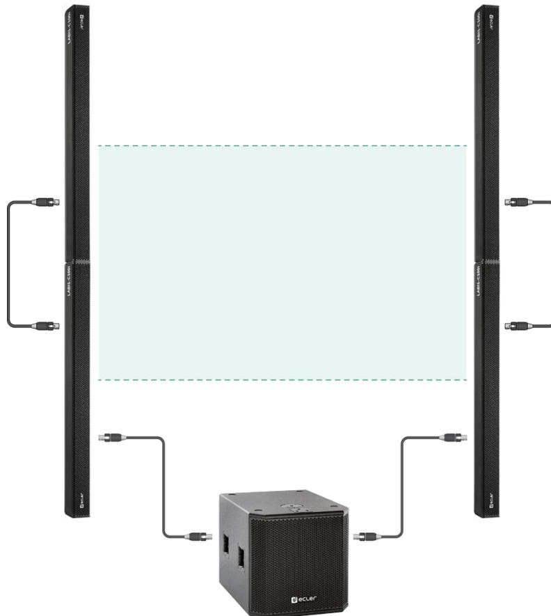
**Nota:** recuerde que la columna superior debe instalarse cabeza abajo
