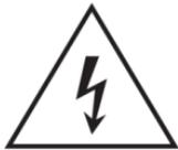
Le symbole d'éclair à tête de flèche dans un triangle équilatéral sert à prévenir l'utilisateur de la présence dans l'enceinte du produit d'une « tension dangereuse » non isolée d'une grandeur suffisante pour constituer un risque d'électrocution pour les personnes.
