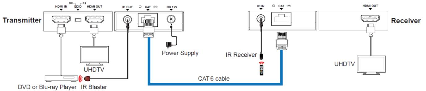
Se necesitan cables de buena calidad Ethernet estándar de categoría 6 (o superiores) para conectar el transmisor y el receptor con el fin de evitar problemas de conexión y mal funcionamiento.
