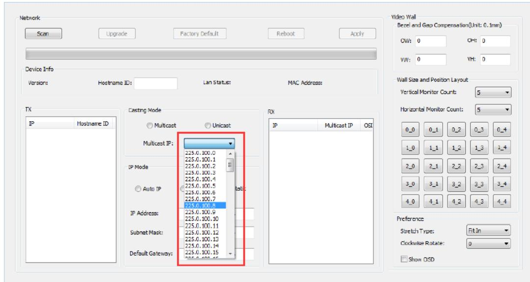
Se debe cambiar el "Vertical Monitor Count" y el "Horizontal Monitor Count" según el tamaño de la estructura video wall deseada.
