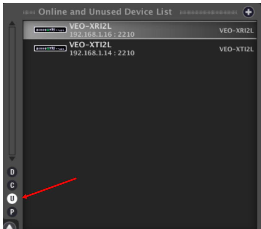
De esta manera se podrá conocer fácilmente qué dirección IP tiene cada equipo. Se debe tener en cuenta que el proceso de descubrimiento mostrará todos los dispositivos conectados en la red independientemente de si se encuentran en el mismo rango visible del ordenador de control o no pero, para poder configurarlos y/o operar con ellos, será imprescindible que tanto la tarjeta de red seleccionada como dichos dispositivos, sí que se encuentren en el mismo dominio de red.
