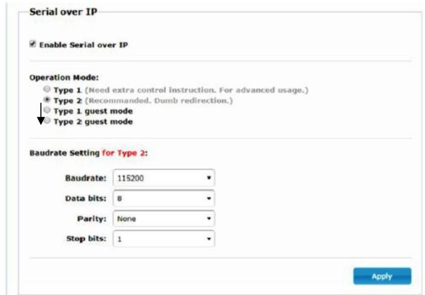
Después de pulsar el botón "Apply" (Aplicar) y reiniciar el dispositivo, es necesario crear una conexión TCP/IP usando la **dirección IP del dispositivo** y el **puerto 6752**.
