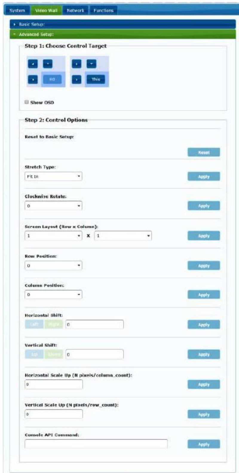
Si se requiere una estructura de vídeo de 3x5, por ejemplo, una vez aplicada la configuración básica, la primera sesión de configuración avanzada tendrá el siguiente aspecto. Es posible actuar sobre un grupo de pantallas simplemente seleccionando los dispositivos de destino.
