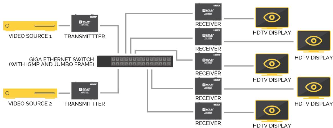
Cuando el VEO-XTI2L y el VEO-XRI2L se quieran usar como un sistema de matriz IP en una conexión multipunto a multipunto, tanto los transmisores como los receptores deben configurarse como dispositivos multicast. Cada receptor puede decodificar el flujo relacionado con el ID de grupo del transmisor deseado.
