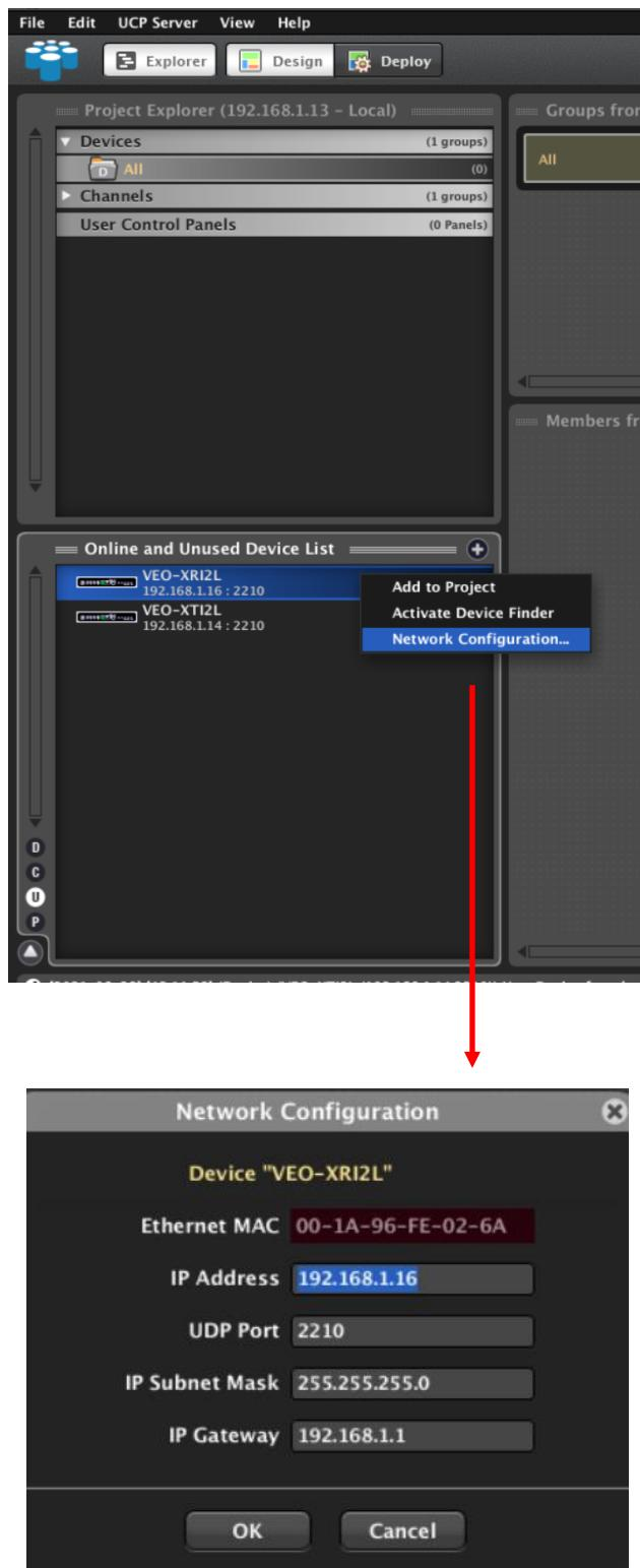
Si se diera el caso de que alguno de los equipos no pertenece a la red de trabajo, se deberá configurar el ordenador de control en el rango de red del dispositivo en cuestión y repetir el proceso para modificar la dirección IP del equipo al rango deseado.
