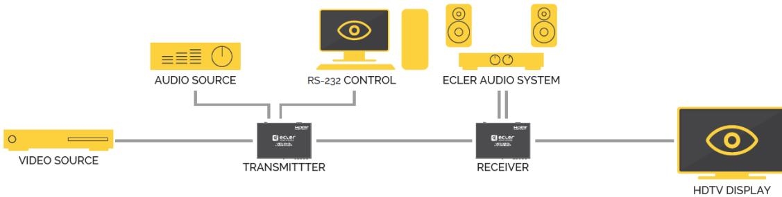
Cuando el VEO-XTI2L y el VEO-XRI2L se conectan como simple extensión en una topología punto a punto, no es necesario realizar ninguna configuración. Los dispositivos tienen un ajuste predeterminado de "Auto IP" (169.254.x.x) y cada transmisor enviará una transmisión de vídeo unicast al receptor correspondiente seleccionando el mismo ID de grupo. La conexión punto a punto es la asignada por defecto.
