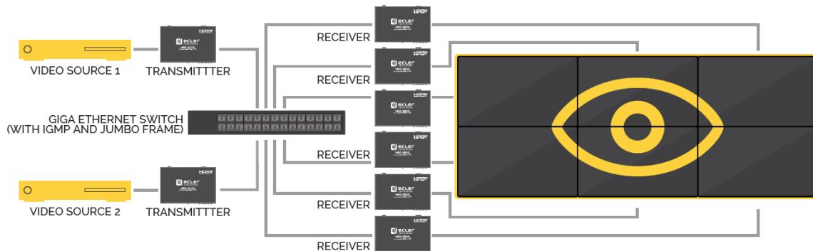
Cuando el VEO-XTI2L y el VEO-XRI2L quieren usarse en modo video wall, tanto los transmisores como los receptores deben configurarse como dispositivos multicast. Cada receptor debe estar configurado en el mismo ID de grupo del transmisor, siguiendo las instrucciones disponibles en el capítulo [Configurar el modo video wall usando el Control Center](#) y [Configurar el modo video wall usando la interfaz](#) web de este manual.
