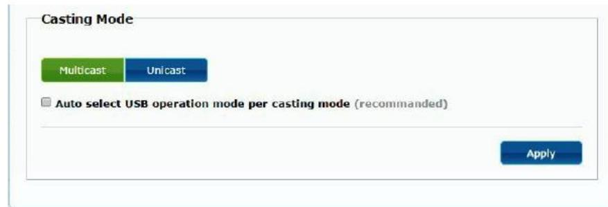
El "Auto select USB operation mode per casting mode" permite cambiar el comportamiento de paso del USB de acuerdo con el modo de difusión seleccionado.
