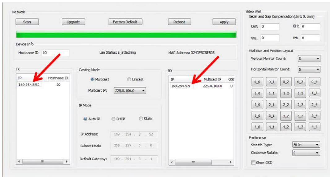
Para poder variar parámetros como la dirección IP, el ID del host, el casting mode o el Ip mode, solamente se debe seleccionar el dispositivo que se desea configurar e introducir los datos requeridos. Esta página también permite realizar un reinicio de dispositivo o un restablecimiento de fábrica desde el control remoto del dispositivo seleccionado.
