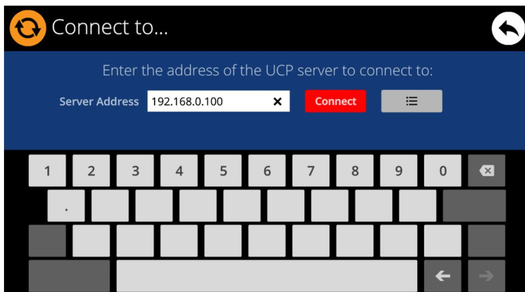
Esta página permite decidir el servidor UCP al que se conectará la unidad como cliente. El servidor UCP puede ser un ordenador, una matriz MIMO404040DN (¡sí, tiene un servidor UCP integrado en su motor!), otra unidad WPNETTOUCH / WPmSCREEN o incluso la misma unidad WPNETTOUCH. En cualquier caso, el servidor UCP alojará y ejecutará un proyecto EclerNet Manager que incluye una serie de UCPs que pueden ser gestionados de forma remota por cualquier cliente UCP.
