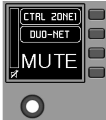
Sollte die Funktion der Lautstärkeregelung für das Bedienelement WPNET4KV nicht freigegeben sein, so erscheint auf dem Display bei Drehen oder Drücken des Drehreglers vorübergehend folgendes Bild, wobei die Zeichen "- -" blinken:
