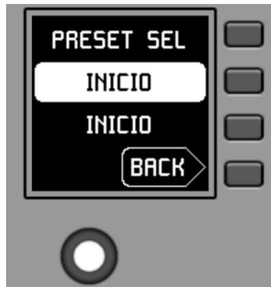
In diesem Menü zeigt S3 das gerade aktive Preset an, während im Feld S2 während der Navigation mit Hilfe des Drehreglers blinkend die Optionen des zugeordneten Karussells der zur Auswahl stehenden Presets angezeigt werden:
