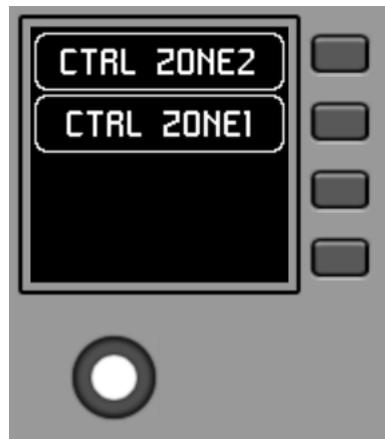
Im obigen Beispiel stehen zwei individuelle Bedientafeln zur Auswahl, deren Rollen die MULTI-Bedientafel übernehmen kann: CTRL ZONE1 und CTRL ZONE2. Mit den Tasten K1 oder K2 kann in diesem Fall die entsprechende Auswahl getroffen werden. Beispiel für die Auswahl der individuellen Bedientafel CTRL ZONE2 (Taste K2):
