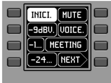
Durch erneutes Drücken der entsprechenden Taste wird dann die Auswahlaktion durchgeführt, so dass die neue, jetzt aktive Preset-Option negativ dargestellt wird (= Preset aktiviert):
