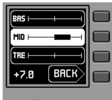
Alle hier vorgenommenen Änderungen werden in Echtzeit ausgeführt und erfordern keinerlei Bestätigung durch Drücken von K5 oder ähnliche Aktionen. Jedoch bewirkt ein längeres Drücken von K5 (> 3 Sekunden) in diesem Menü ein "Reset" der EQ-Filter, womit der Gain-Wert auf 0 gesetzt wird ("flacher" EQ).
