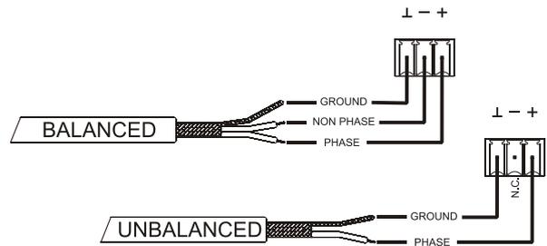
Les connecteurs de sortie du signal sont de type borniers vissables à trois contacts. L'assignation du câblage est la suivante :
