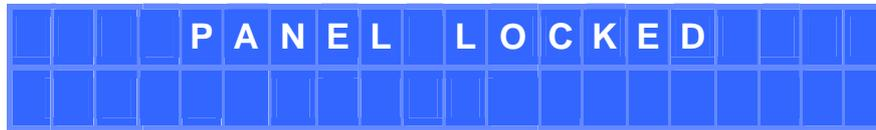
Pour réactiver les commandes de la face avant, il est nécessaire de saisir le mot de passe mémorisé. Pour cela, affichez le menu de verrouillage (touches PARAM gauche et droite simultanément, pendant 2 secondes). L'écran suivant s'affiche :
