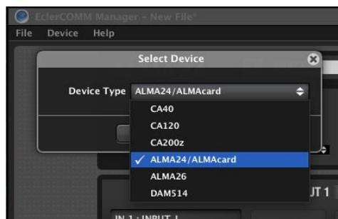
A continuación, pulsando sobre la tecla **Connect with Device** es posible establecer la comunicación con el dispositivo hardware, tras contestar a la pregunta de sincronización (**SEND** o enviar configuración actual al dispositivo hardware o **GET**, volcar en la aplicación la configuración actualmente en el dispositivo hardware):
