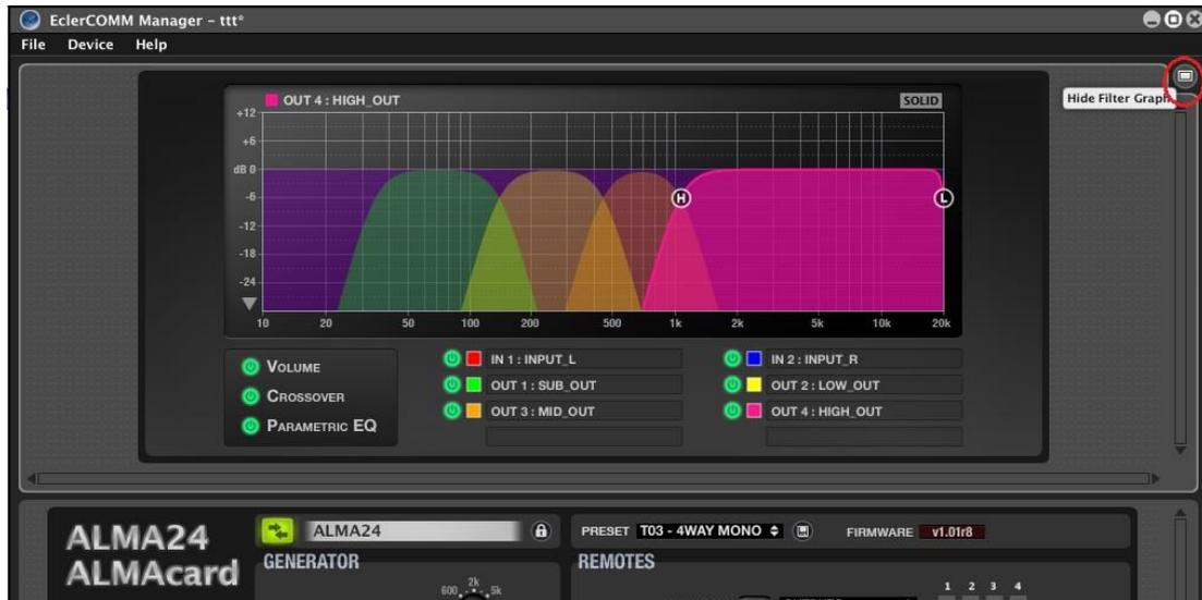
En dicha ventana puede visualizarse una representación gráfica del volumen, procesamiento de crossovers y ecualización paramétrica de cada una de las entradas y salidas, siendo incluso posible ajustar en tiempo real los parámetros de los filtros en pantalla, si se pulsa y arrastra sobre la superficie de la pantalla uno de los iconos circulares disponibles en cada filtro.
