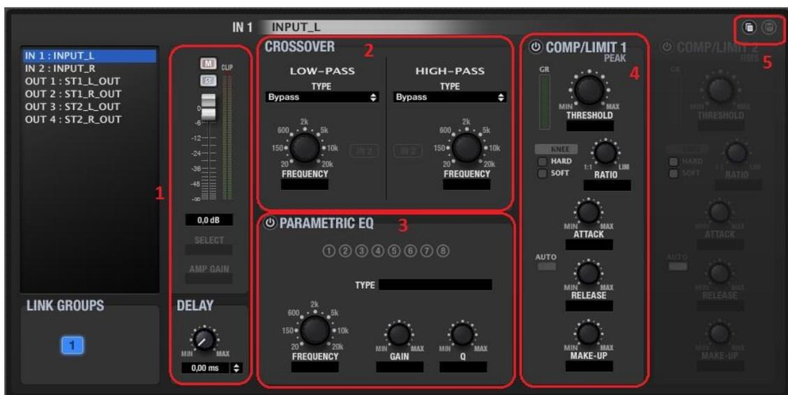
1. **Lautstärkeeinstellung, MUTE, Polaritätsumkehrung und Verzögerung** (bis zu 1 Sekunde, darstellbar in Zeit- oder Distanzeinheiten). Des Weiteren sind an jedem Eingangskanal 2 VU-Meter enthalten, eines zur Pegelkontrolle vor Signalverarbeitung ("Pre") und eines zur Pegelkontrolle nach Signalverarbeitung ("Post").
