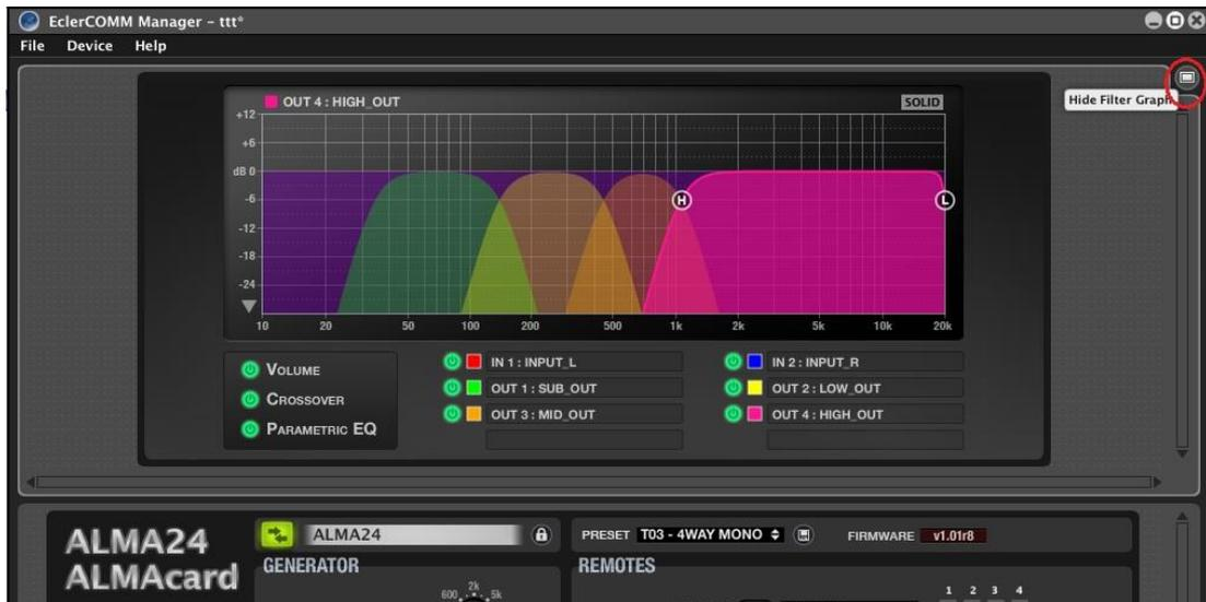
Dieses Fenster ermöglicht eine grafische Darstellung der Lautstärke und der Crossover- und der parametrischen EQ-Filter aller Ein- und Ausgänge sowie die Einstellung der Parameter dieser Filter in Echtzeit auf dem Display. Hierfür müssen die jeweils für jeden Filter auf dem Display verfügbaren runden Icons gedrückt und über die Bildschirmoberfläche gezogen werden.
