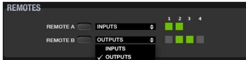
Jedes Preset speichert die Funktion, die im Moment des Speicherns den REMOTE-Ports zugewiesen ist (unterschiedliche Presets können unterschiedliche Funktionen für ein und denselben REMOTE-Port enthalten).
