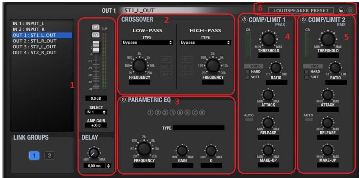
1. **Lautstärkeeinstellung, MUTE, Polaritätsumkehrung und Verzögerung** (bis zu 1 Sekunde, darstellbar in Zeit- oder Distanzeinheiten). Des Weiteren sind an jedem Ausgangskanal 2 VU-Meter vorhanden, eines zur Pegelkontrolle vor Signalverarbeitung ("Pre") und eines zur Pegelkontrolle nach Signalverarbeitung ("Post").
