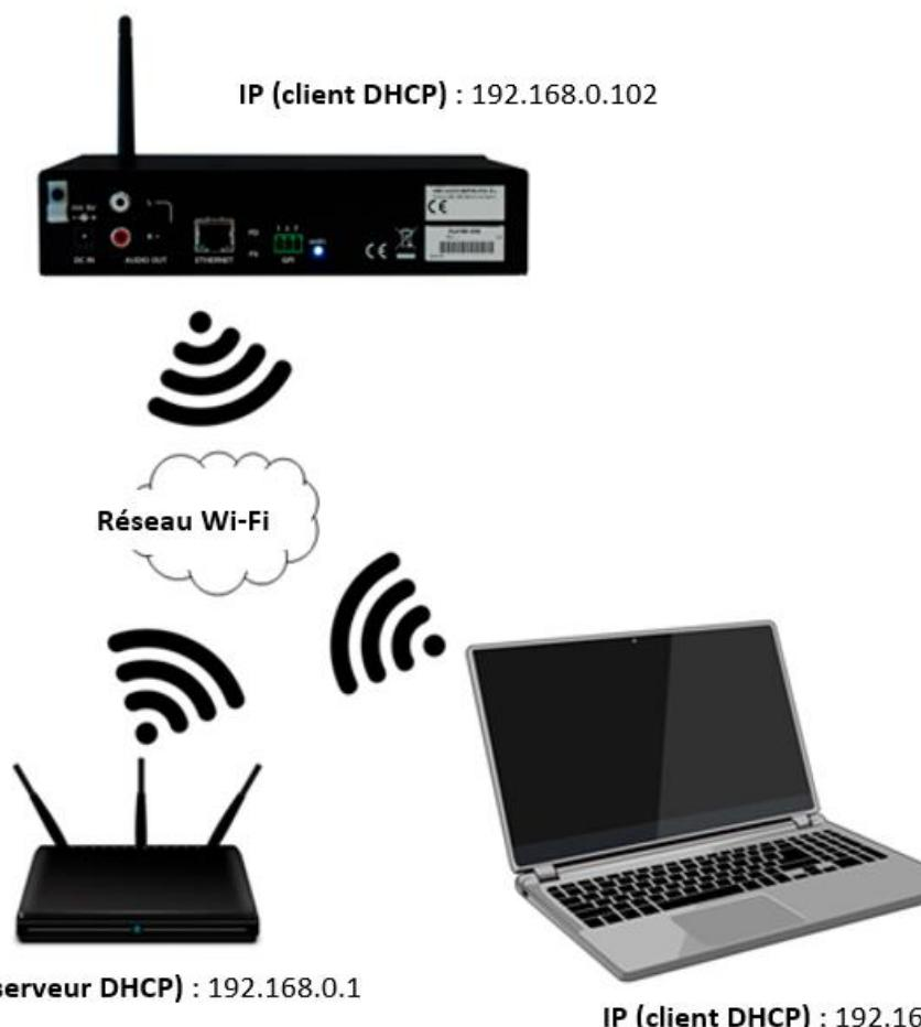
Figure 12 : exemple de connexion à un réseau local par l'interface réseau Wi-Fi (sans fil).
