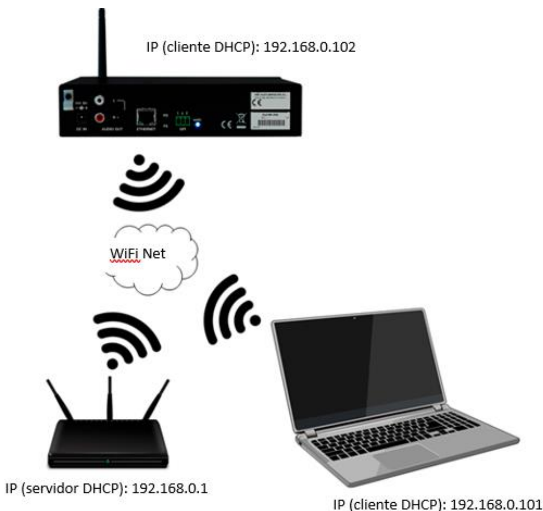
Figura 12: ejemplo de conexionado a una red local a través de la interfaz de red WiFi (inalámbrica)
