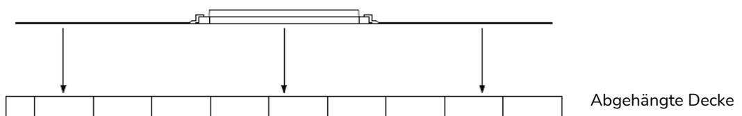
3. Befestigen Sie den montierten Lautsprecher VIC6X, VIC8X oder VICSB8X an der in die Zwischendecke eingesetzten Ankerbrücke.techo.
