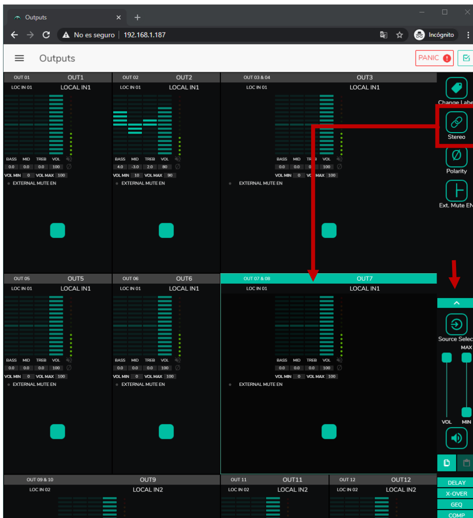
Abbildung 35: als Stereo-Paare konfigurierte Ausgänge
