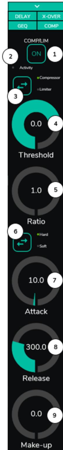
Abbildung 40: Einstellung des Kompressors eines Ausgangs
