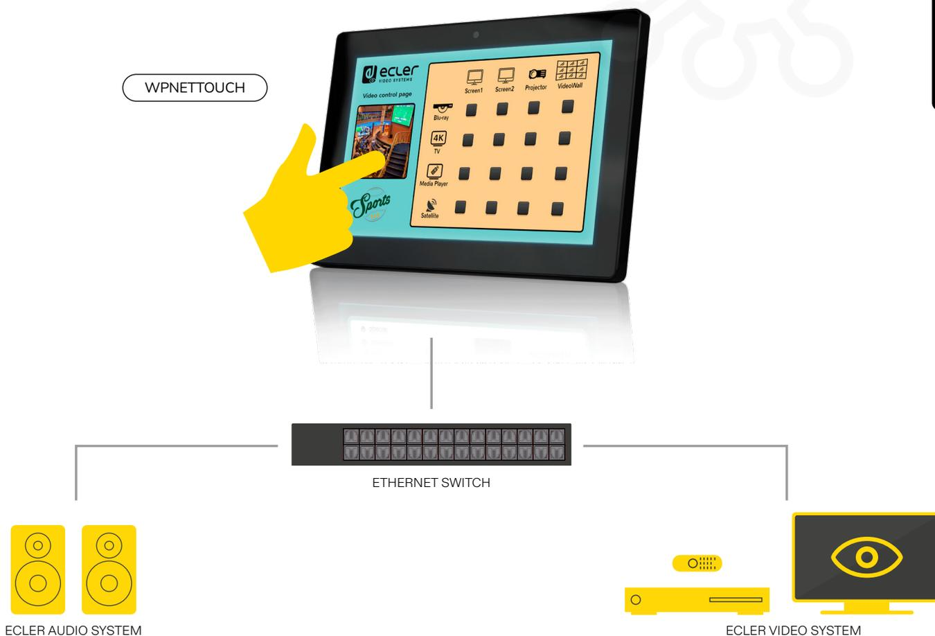
**WPNETTOUCH** ist ein TFT-Touchpanel zur Fernbedienung, das mit allen EclerNet-Produkten kompatibel. Es besteht aus einem kapazitiven 10" Touchscreen und einem Client-Server-UCP (User Control Panel): wird in einer EclerNet-Anlage mindestens ein WPNETTOUCH eingesetzt, so ist zur Steuerung der Geräte und zur Bedienung der im Projekt erstellten UCP-Panels kein Rechner erforderlich.
