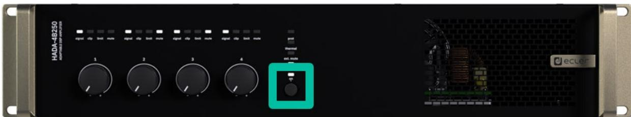
**Um in den Standby-Modus zu gelangen**, halten Sie die ON-Taste gedrückt, bis alle LEDs auf der Vorderseite einmal blinken. Die Schutz-LED (rot) leuchtet zusammen mit der ON-LED (weiß), um anzuzeigen, dass der Standby-Modus aktiv ist.
