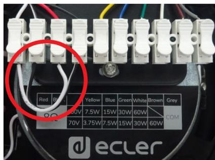
2. Schließen Sie alle Kabel des AVICCAN entsprechend den Farben an die Anschlussklemmen des Lautsprechers an. Die beiden kürzeren Kabel (weiß und schwarz) sind für den 8 $\Omega$ -Anschluss.
