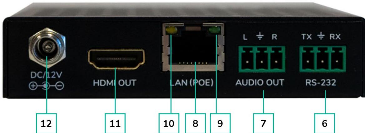
6. **RS-232:** Serieller Anschluss zur Fernsteuerung. Unterstützt Signaldurchleitung.
