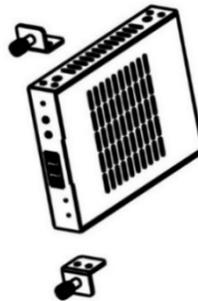
2. Setzen Sie das Produkt mit den Montageösen in ein 3U-Rack ein (bis zu 12 Geräte können vertikal eingebaut werden), wie in der Abbildung unten dargestellt:
