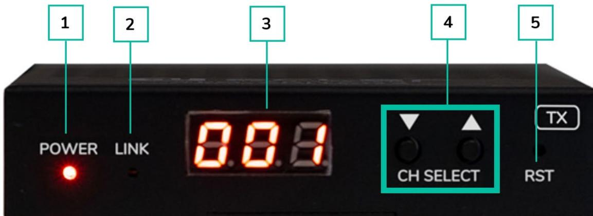
1. **LED-Anzeige POWER:** Die LED-Anzeige blinkt, wenn das Gerät mit Strom versorgt wird, und leuchtet (ROT), wenn der Einschaltvorgang abgeschlossen ist.
