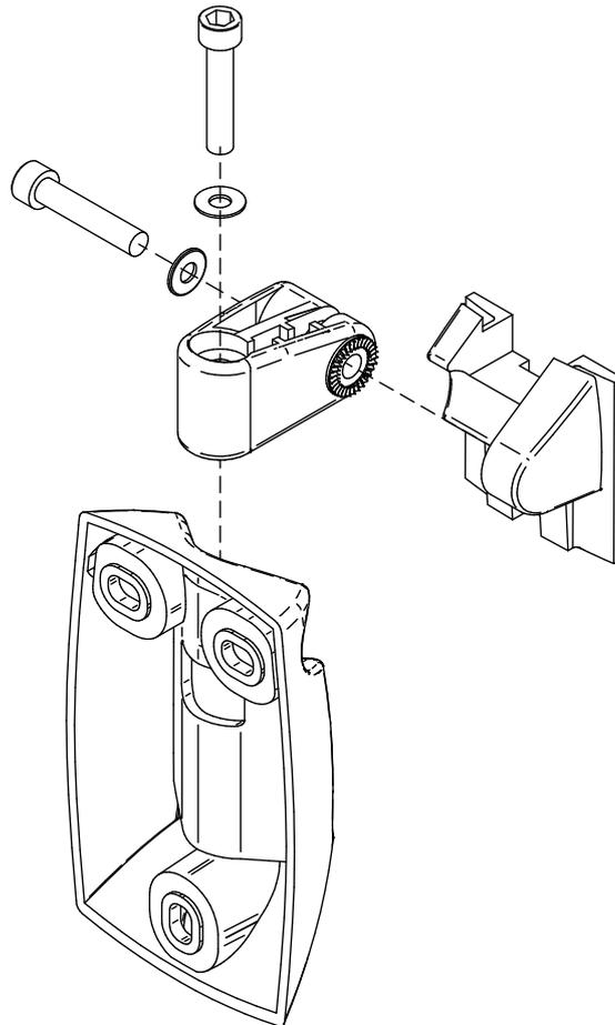
5. Sitúe la caja acústica en su posición final deslizándola verticalmente hacia abajo para que la guía de su cara posterior encaje con la guía del soporte.
