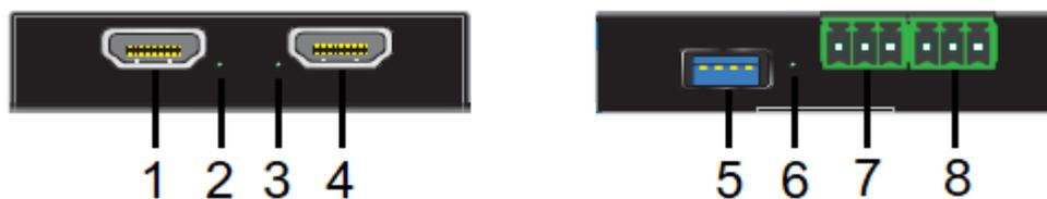
1. **HDMI® OUT:** Schließen Sie diesen Ausgang an einen lokalen Bildschirm oder an ein anderes Gerät zur HDMI®-Verteilung an
