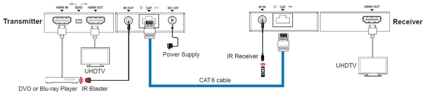
Um Verbindungsprobleme und Fehlfunktionen zu vermeiden, sind für die Verbindung des Senders mit dem Empfänger Standard-Ethernet-Kabel der Kategorie 6 (oder höher) von guter Qualität erforderlich.
