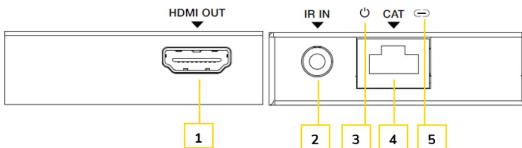
1. **HDMI® OUT BUCHSE:** Verbinden Sie diesen Ausgang mit dem HDMI®-Display.
