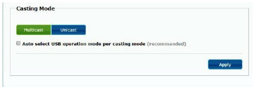
El "Auto select USB operation mode per casting mode" permite cambiar el comportamiento de paso del USB de acuerdo con el modo de difusión seleccionado.
