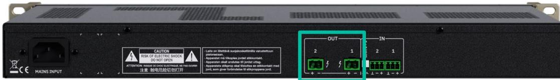
**!** Respectez toujours la polarité relative des sorties (+ et – sur chaque connecteur de sortie), du câblage et des enceintes.
