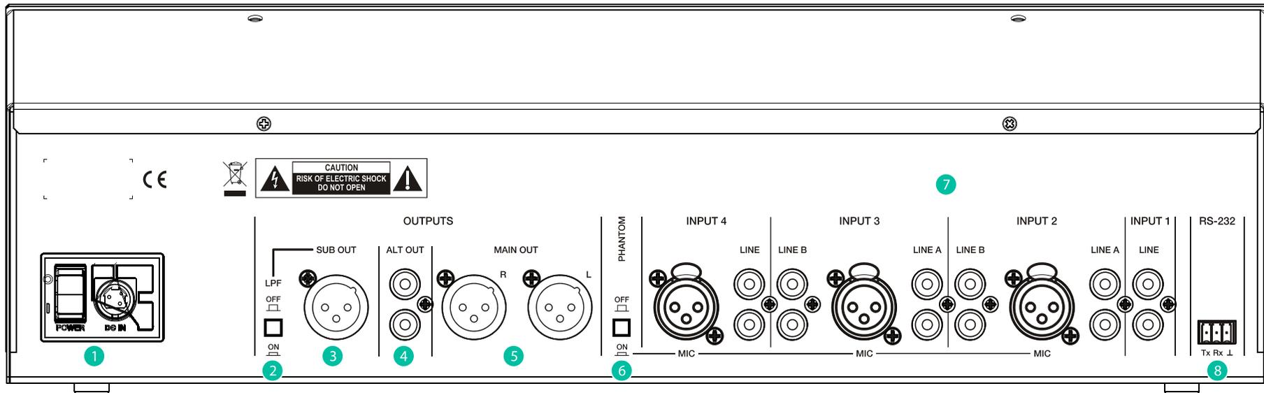
1. **ON/OFF:** Schalter zum Einschalten des Geräts. Neben diesem Schalter befindet sich der Anschluss für das Netzteil sowie ein Clip zum sicheren Befestigen des Netzteilkabels.
