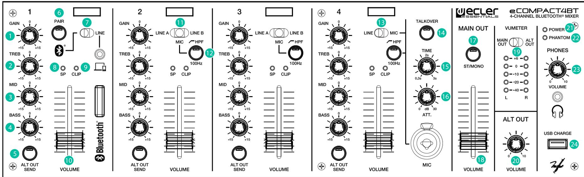
1. **GAIN:** Gain-Regler für das Eingangs-Audiosignal des Kanals. Verfügbar an den 4 Mischkanälen.
