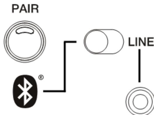
1. Schalter zur Auswahl der Audioquelle für Kanal 1 und Mini-Jack-Anschluss am vorderen Bedienfeld
