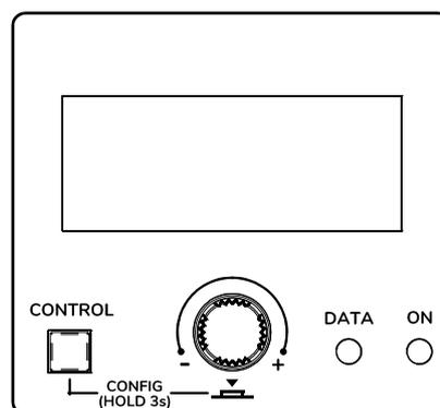
Figura 16: pantalla LCD del panel frontal y teclas de control
