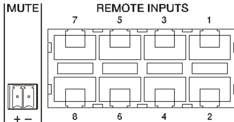
Figura 4: entradas remotas (paneles murales de control)
