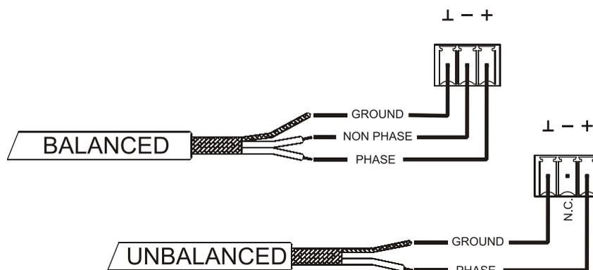
Figura 10: conexión de salida de audio balanceada
