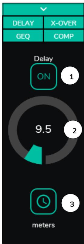
Permite el ajuste de un retardo (delay) en milisegundos, metros o pies, que se aplicará entre su entrada y su salida. Es independiente para cada salida. Útil para ajustar sistemas de refuerzo sonoro que utilicen altavoces de refuerzo alejados del sistema principal y evitar retardo de señales en la audiencia. Disponible para las salidas de 1 a 8 en todos los dispositivos HUB.
