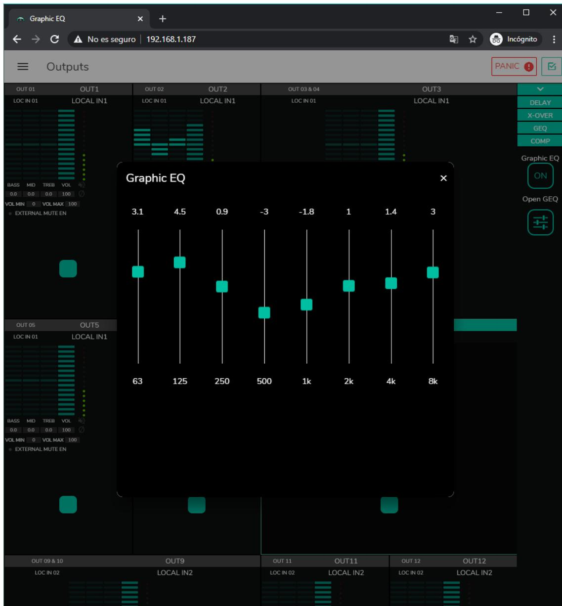
Figura 54: ajuste del ecualizador gráfico en una salida
