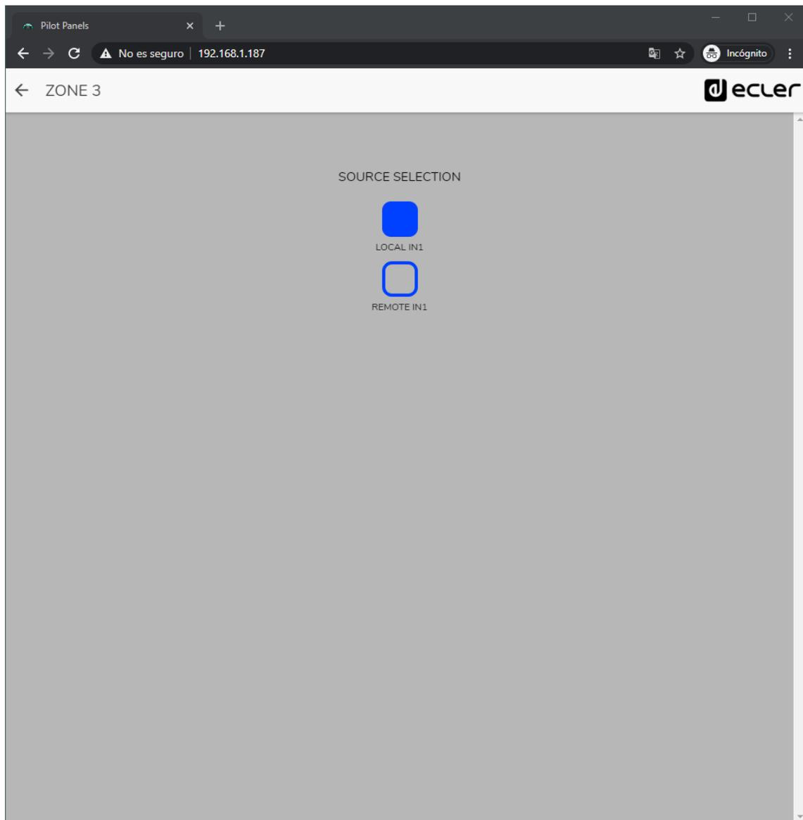
Figura 75: pilot panel únicamente con selección de fuente local (HUB) y remota (eMCONTROL + WPaMIX-T)
