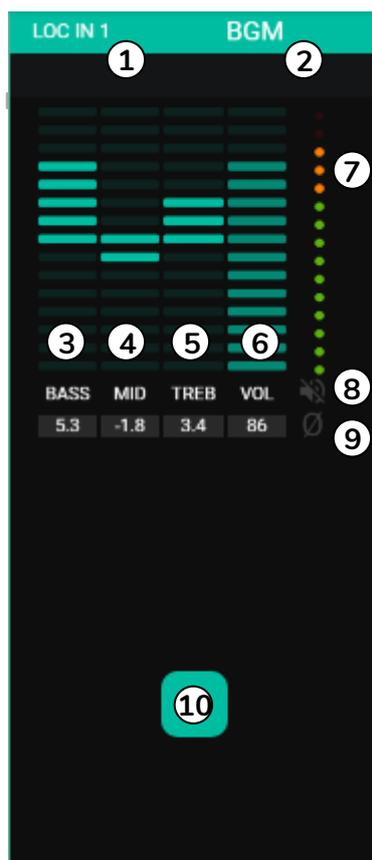
1. Indicador de entrada local, conectores en el panel posterior (LOC) o remota (REM), paneles de control remoto con entrada de audio, más la numeración correspondiente.
