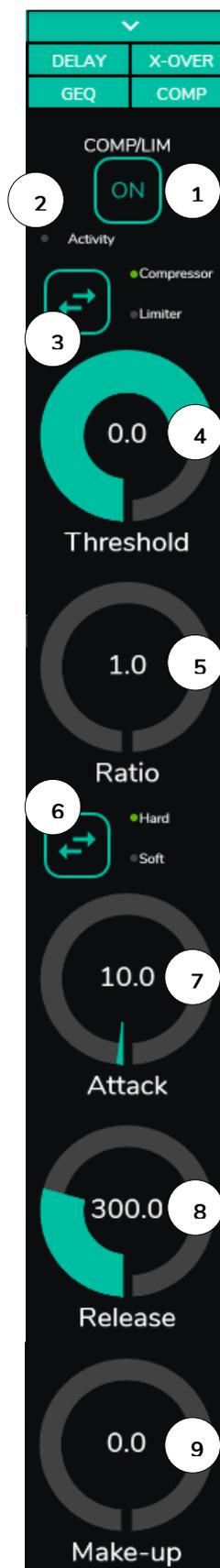
Figura 55: ajuste del compresor de una salida
