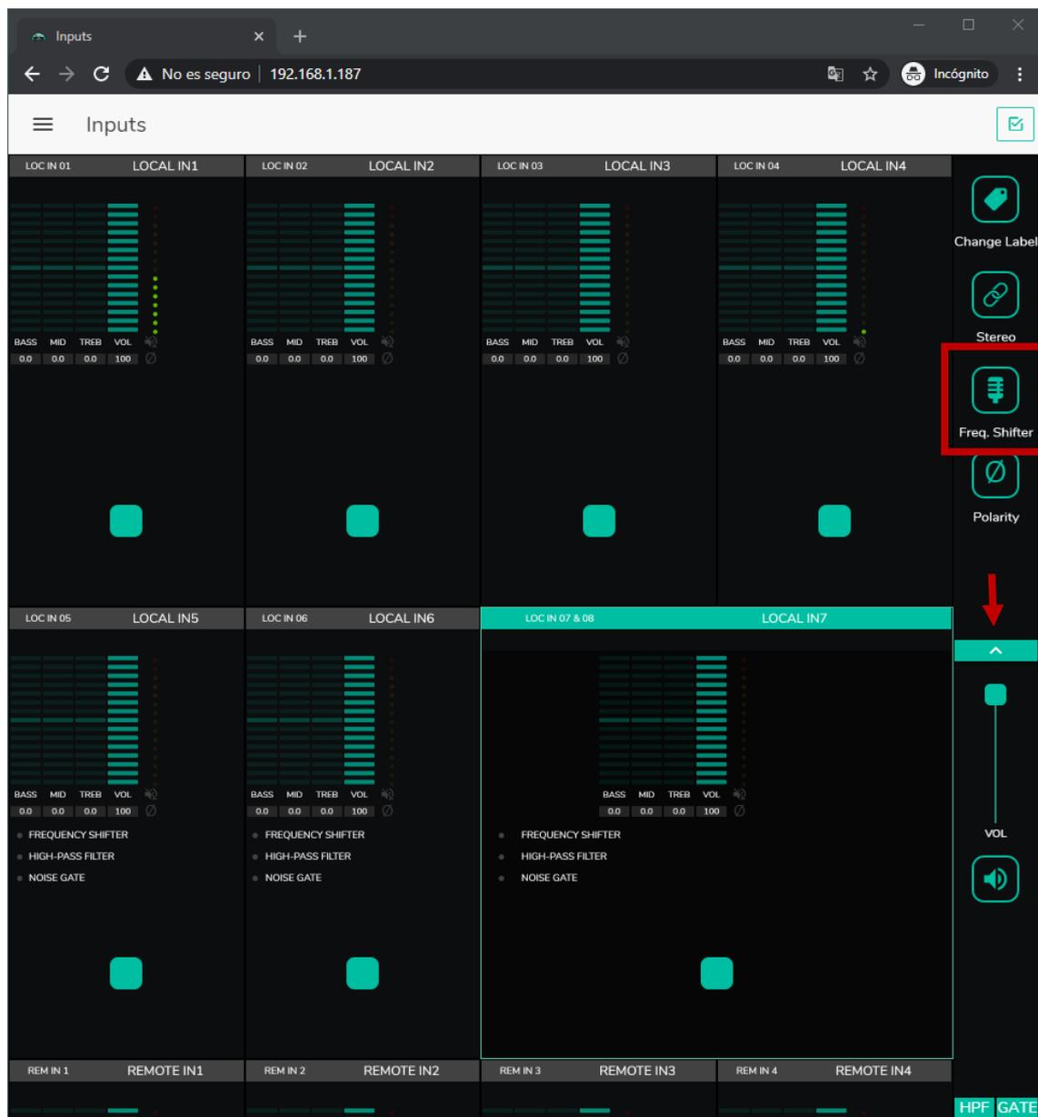
Figura 43: activación del cancelador de realimentaciones (FREQUENCY SHIFTER)
