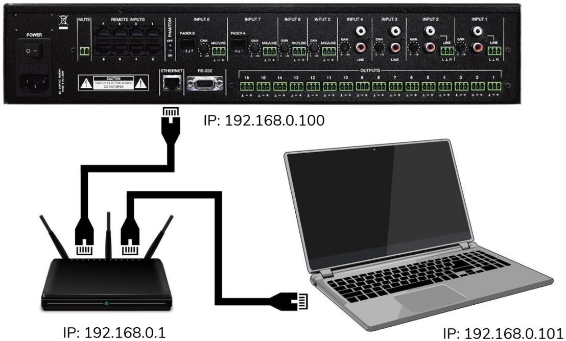
Figura 18: conexión en red local LAN
