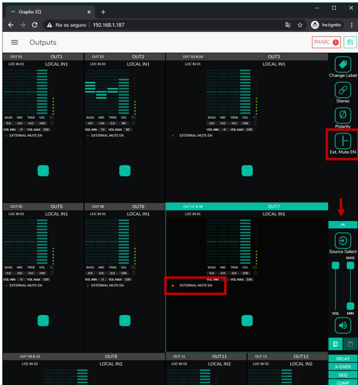
Figura 51: activación del enmudecimiento externo por cierre de contacto en una salida
