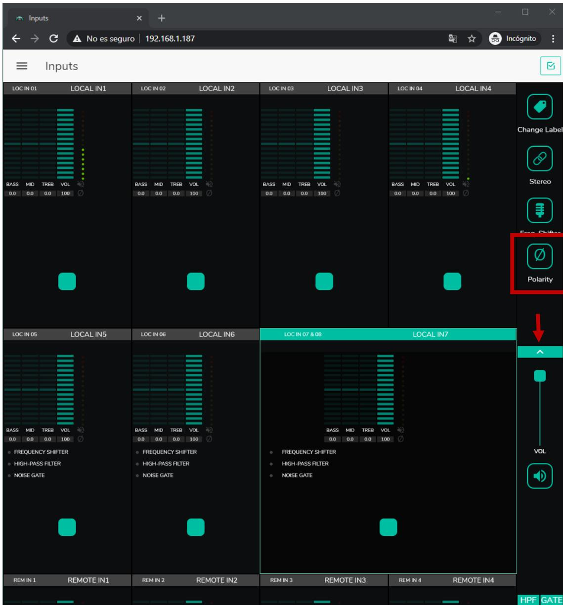
Figura 44: cambio de polaridad de la señal de entrada
