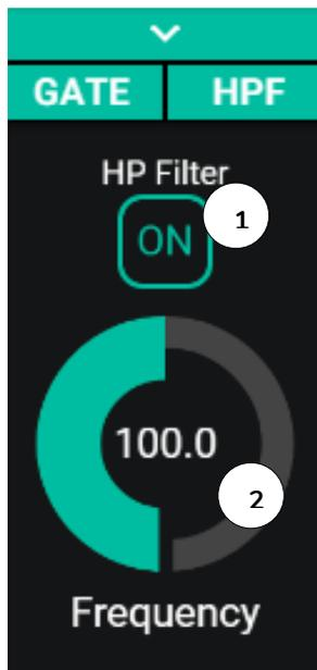
Útil para atenuar el efecto proximidad de un micrófono (realce en frecuencias bajas) o eliminar/atenuar ruido de fondo, ruido de manipulación, etc.:
