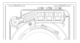
**ANMERKUNG:** Sollten Sie das System versehentlich an 8  $\Omega$  anschließen, so erleidet das Gerät zwar keinen Schaden, die Leistung bleibt jedoch weit unter dem Normalwert.
