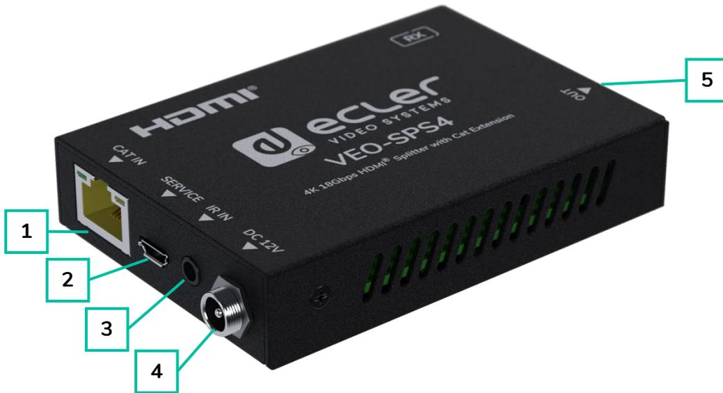
1. **CAT IN (CAT-EINGANG):** Port für den Anschluss an den VEO-SPS42-Splitterausgang mit einem Cat-5e- oder höherwertiges Kabel. Es werden nur Punkt-zu-Punkt-Verbindungen unterstützt.
