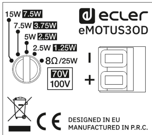
Wird der Lautsprecher in 70V-Anlagen benutzt, so werden die Leistungen der 100V-Einstellung gegenüber den am Schalter angegebenen Leistungen um die Hälfte reduziert. Im Falle von 50V-Anlagen reduziert sich die Leistung auf ein Viertel.
