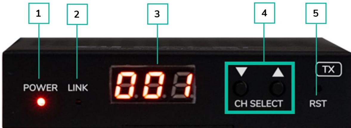
1. **LED DE ENCENDIDO:** el LED parpadea cuando el aparato recibe alimentación y permanece encendido (rojo) una vez finalizada la puesta en marcha.
