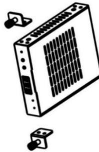
2. Setzen Sie das Produkt mit den Montageösen in ein 3U-Rack ein (bis zu 12 Geräte können vertikal eingebaut werden), wie in der Abbildung unten dargestellt:
