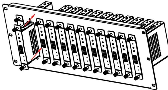
3. Befestigen Sie die Montageösen mit Schrauben am Rack, um die Montage abzuschließen, wie in der Abbildung unten dargestellt:
