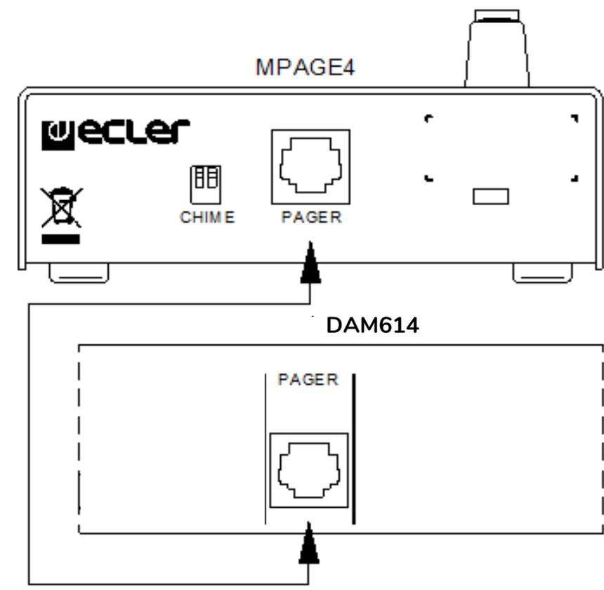
2. Activation de la mélodie de carillon (en option). Les 2 micro-interrupteurs CHIME (6) du panneau arrière de la console MPAGE4 permettent : d'activer ou non la mélodie de carillon (les deux sont sur OFF), ou de sélectionner une mélodie de carillon parmi trois choix, en modulant les positions (ON-OFF, OFF-ON et ON-ON). Position ON = micro-interrupteur en bas.
