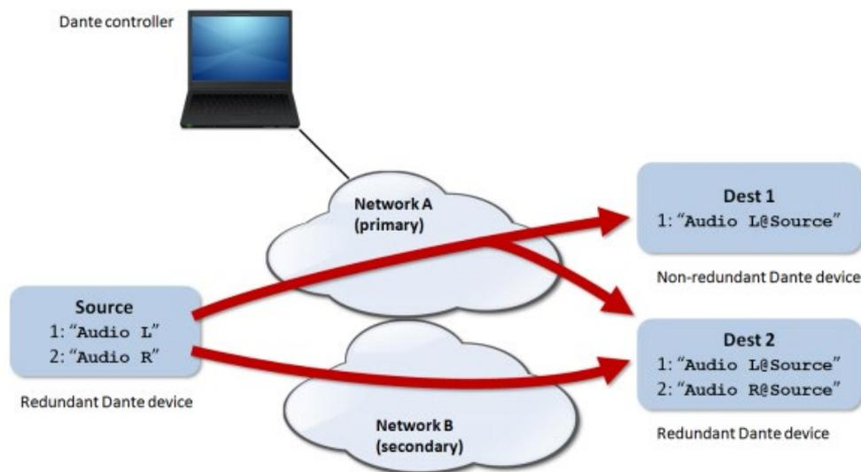
**Remarque :** dans ce mode, si (par erreur) les ports primaire et secondaire sont connectés au même réseau Ethernet, l'application Dante Controller n'aura plus accès au contrôle de la configuration du réseau et au routage DANTE™/AES67 des ports de la MIMO4040CDN. Ce contrôle est récupéré lorsque l'un des deux est déconnecté du même réseau que l'autre.
