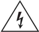
Le symbole d'éclair à tête de flèche dans un triangle équilatéral sert à prévenir l'utilisateur de la présence dans l'enceinte du produit d'une « tension dangereuse » non isolée d'une grandeur suffisante pour constituer un risque d'électrocution pour les personnes.
