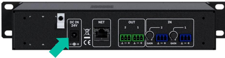
El aparato se encenderá automáticamente y el led ON del panel frontal se iluminará en verde.
