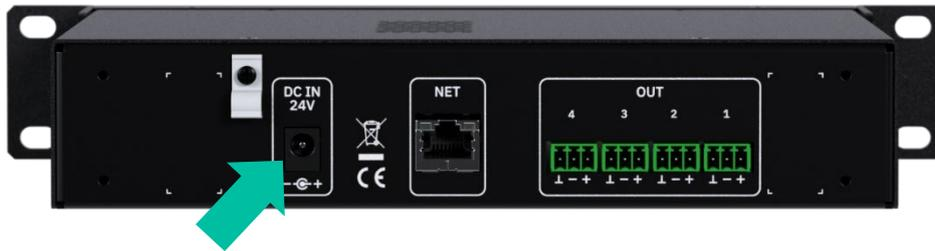
Das Gerät schaltet sich automatisch ein und die ON-LED auf der Vorderseite leuchtet grün.
