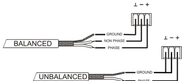
**!** Für **asymmetrischen Betrieb** schließen Sie den Massepol ⊥ mit dem Minuspol kurz wie auf dem obigen Bild zu sehen ist.
