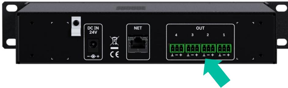
Les connecteurs de sortie des signaux sont des borniers à vis à 3 pôles. Le câblage est :
