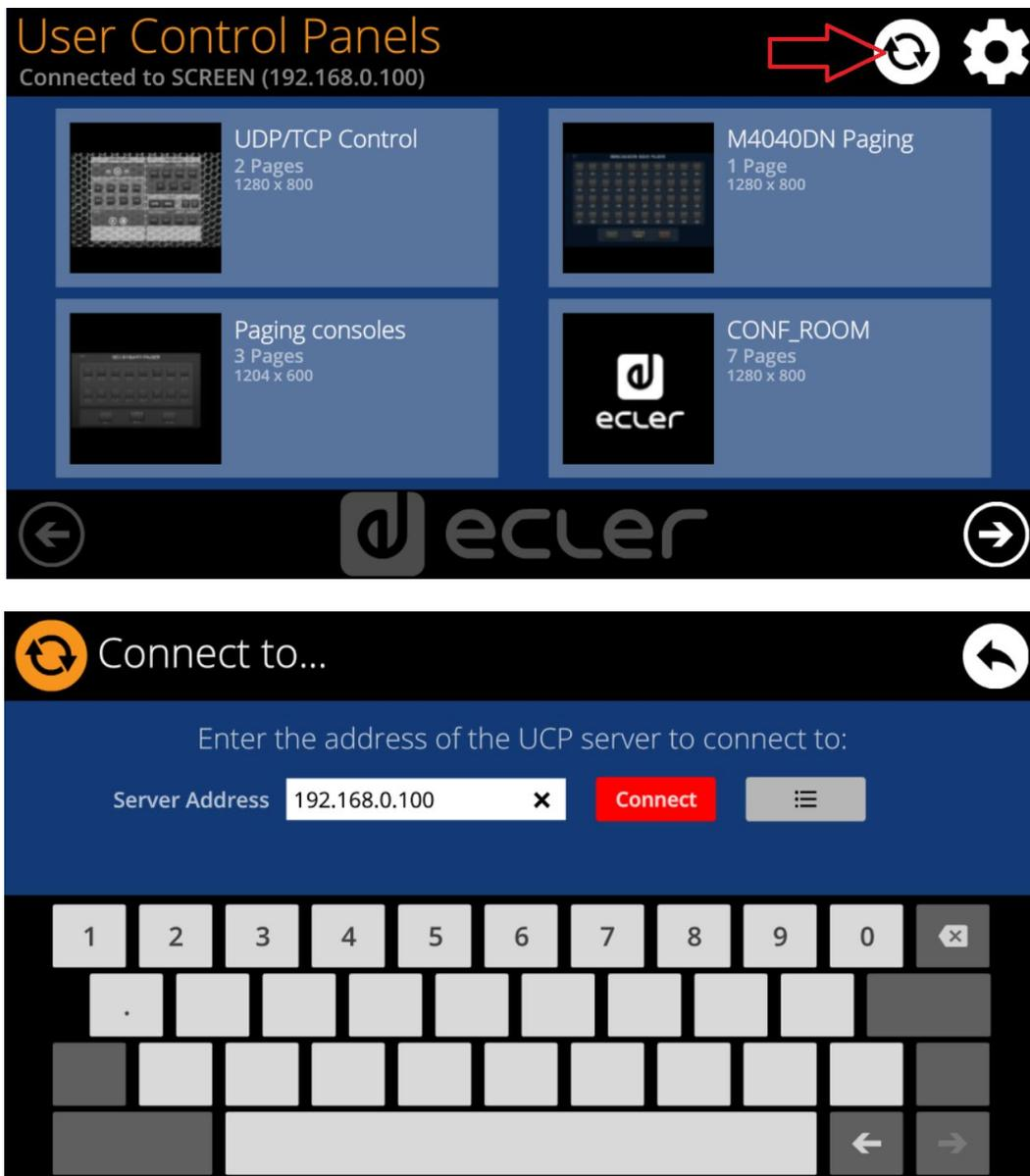
Esta página permite decidir el servidor UCP al que se conectará la unidad como cliente. El servidor UCP puede ser un ordenador, una matriz MIMO404040DN (¡sí, tiene un servidor UCP integrado en su motor!), otra unidad WPNETTOUCH / WPmSCREEN o incluso la misma unidad PAGENETDN / WPNETTOUCH. En cualquier caso, el servidor UCP alojará y ejecutará un proyecto EclerNet Manager que incluye una serie de UCPs que pueden ser gestionados de forma remota por cualquier cliente UCP.
