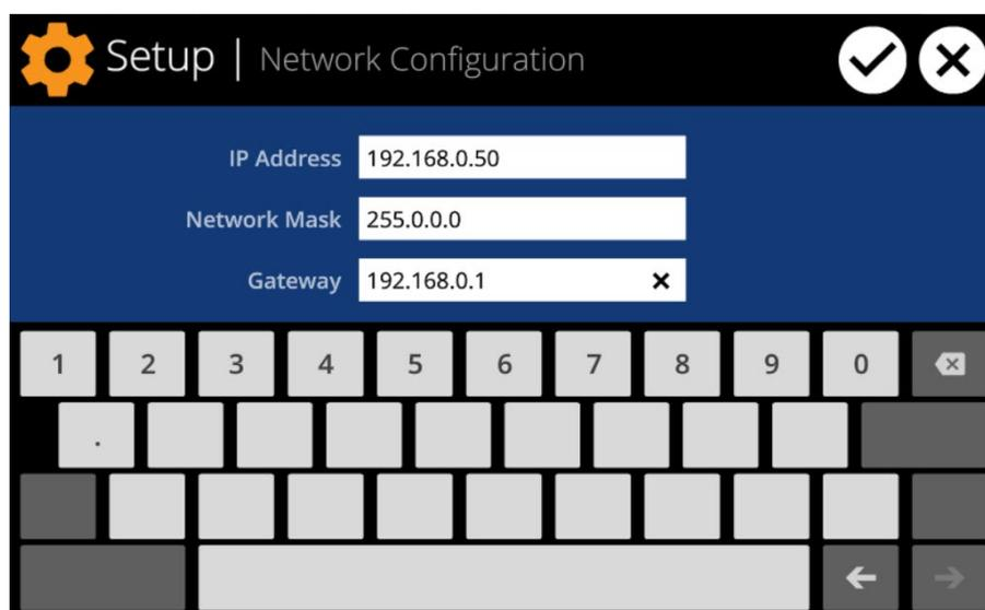
In diesem Menü können folgende Netzwerk-Verbindungsparameter des WPNETTOUCH geändert werden: IP-Adresse, Netzwerkmaske und Gateway.
