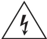
Der Blitz im gleichseitigen Dreieck soll den Benutzer vor nicht isolierter, "gefährlicher Spannung" im Inneren des Gerätes warnen, die hoch genug sein kann, um einen Stromschlag zu verursachen.
