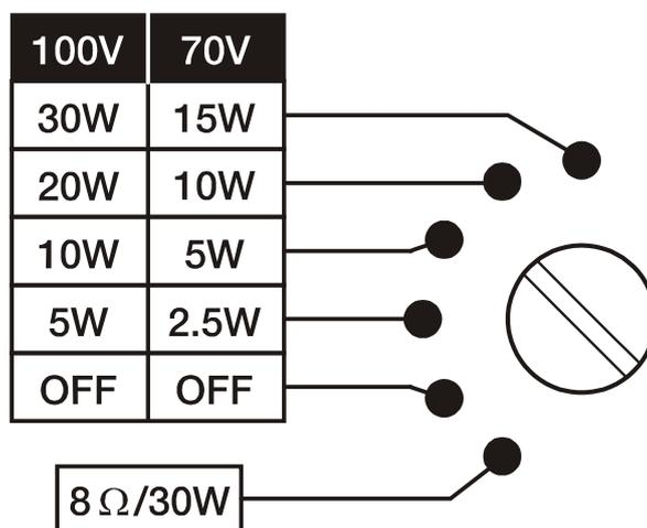
Figura 1: selector de potencias del panel posterior
