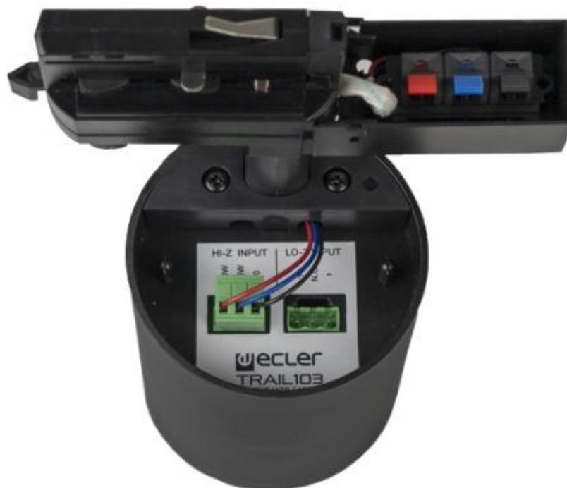
Para realizar la conexión en el altavoz, dispone de un conector tipo Euroblock macho, el cual se conecta a la entrada de alta o baja impedancia (**HI-Z IN** o **LO-Z IN**), dependiendo del tipo de instalación:
