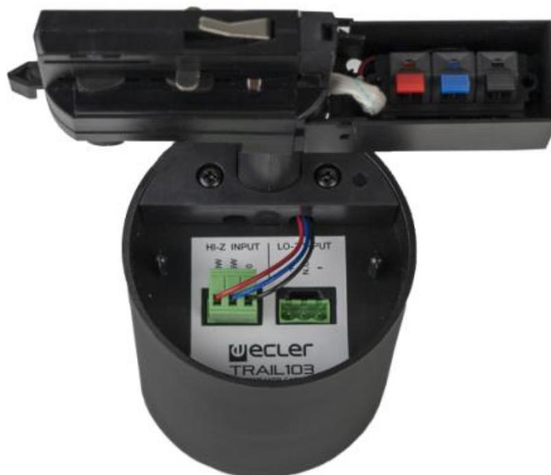
Für den Anschluss im Lautsprecher gibt es einen Euroblock-Steckverbinder, der, je nach Art der Installation, an den hochohmigen oder an den niederohmigen Eingang angeschlossen wird (**HI-Z IN** oder **LO-Z IN**):
