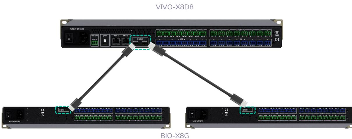
**💡** Jede VIVO-X8D8-Einheit kann bis zu zwei BIO-X8G-Geräte unterstützen.
