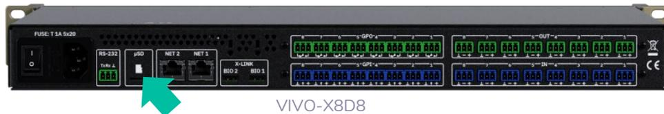
Um die microSD-Karte einzulegen, schieben Sie sie in den Steckplatz, bis ein Klickgeräusch zu hören ist. Um sie herauszunehmen, drücken Sie die microSD-Karte in den Steckplatz, bis ein Klickgeräusch zu hören ist, dann wird sie freigegeben.
