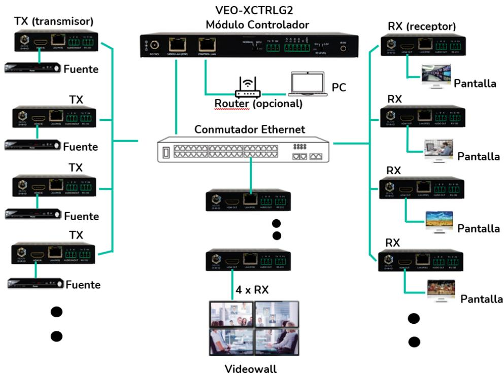
**!** Cuando el conmutador de red no es compatible con PoE, entonces VEO-XTI1CG2, VEO-XRI1CG2 y VEO-XCTRLG2 deberían ser alimentados por el adaptador de potencia de DC incluido.
