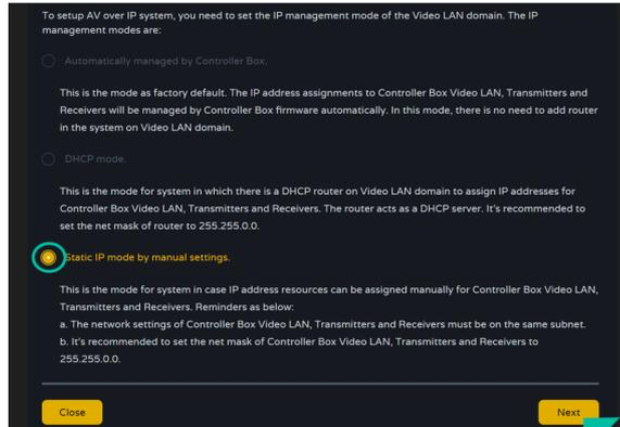
Pulse «Next» (Siguiente) y, a continuación, establezca manualmente la dirección IP, la máscara de subred y la pasarela de la LAN de vídeo y entonces pulse Siguiente.
