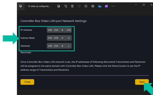
**!** Es wird dringend empfohlen, eine IP-Netzwerk-Domäne zu verwenden, die sich von der des Steuerungs-LAN-Anschlusses unterscheidet.
