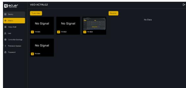
**⚠ Bitte beachten Sie, dass der Benutzer auch einen Sender auf die Option „All receivers“ (Alle Empfänger) ziehen und ablegen kann.** Dadurch wird das ausgewählte Gerät automatisch allen verfügbaren Empfängern zugewiesen. Wenn die Empfänger ausgeblendet werden, beachten Sie, dass sie aus dem Matrixbereich entfernt werden, wenn eine Gruppe von Empfängern einer Videowand zugewiesen wird. Wenn die Videowand entfernt wird, werden die Empfänger im Matrixbereich wieder verfügbar.
