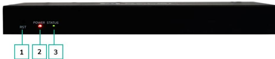
1. **RESET-Taste:** Halten Sie diese Taste solange gedrückt (ca. 10 Sekunden), bis die Status-LED-Anzeige zu blinken beginnt: der Controller wird automatisch neu gestartet.
