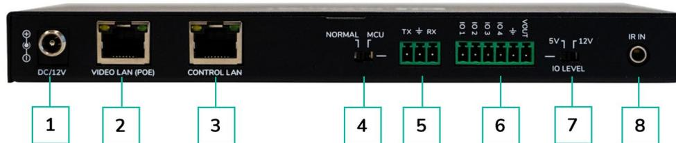
1. **DC 12V:** 12V/1A DC Stromversorgungs-Anschluss
