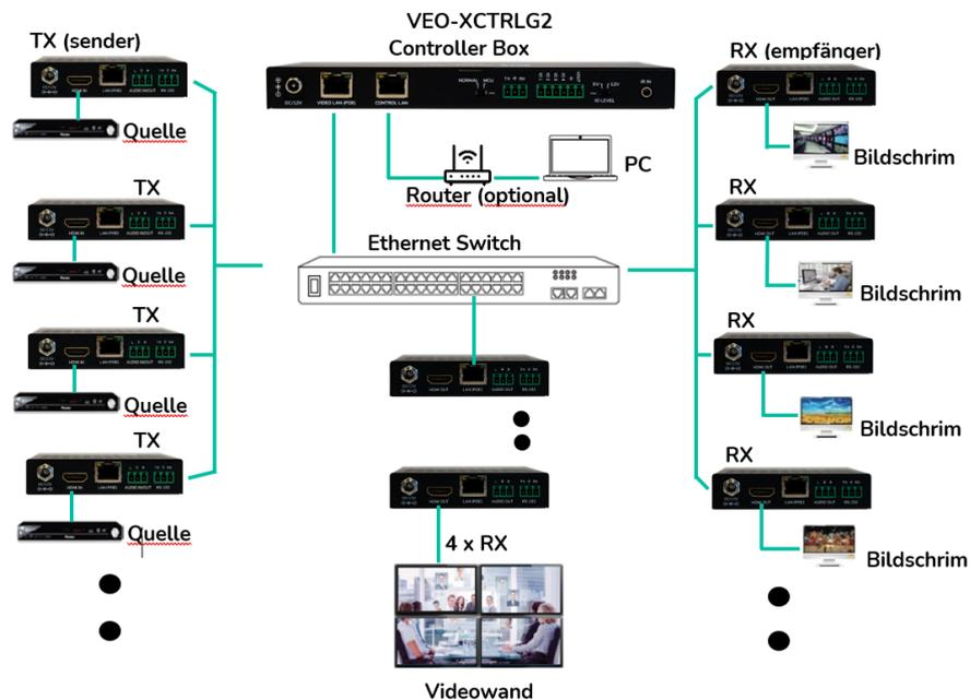
**!** Sollte der Netzwerk-Switch die PoE-Funktion nicht unterstützen, so müssen die Geräte VEO-XTI1CG2, VEO-XRI1CG2 und VEO-XCTRLG2 über das mitgelieferte DC-Netzteil mit Strom versorgt werden.
