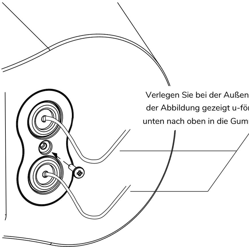
Verlegen Sie bei der Außeninstallation die Kabel wie in der Abbildung gezeigt u-förmig und führen Sie sie von unten nach oben in die Gummitülle am Lautsprecher ein.
