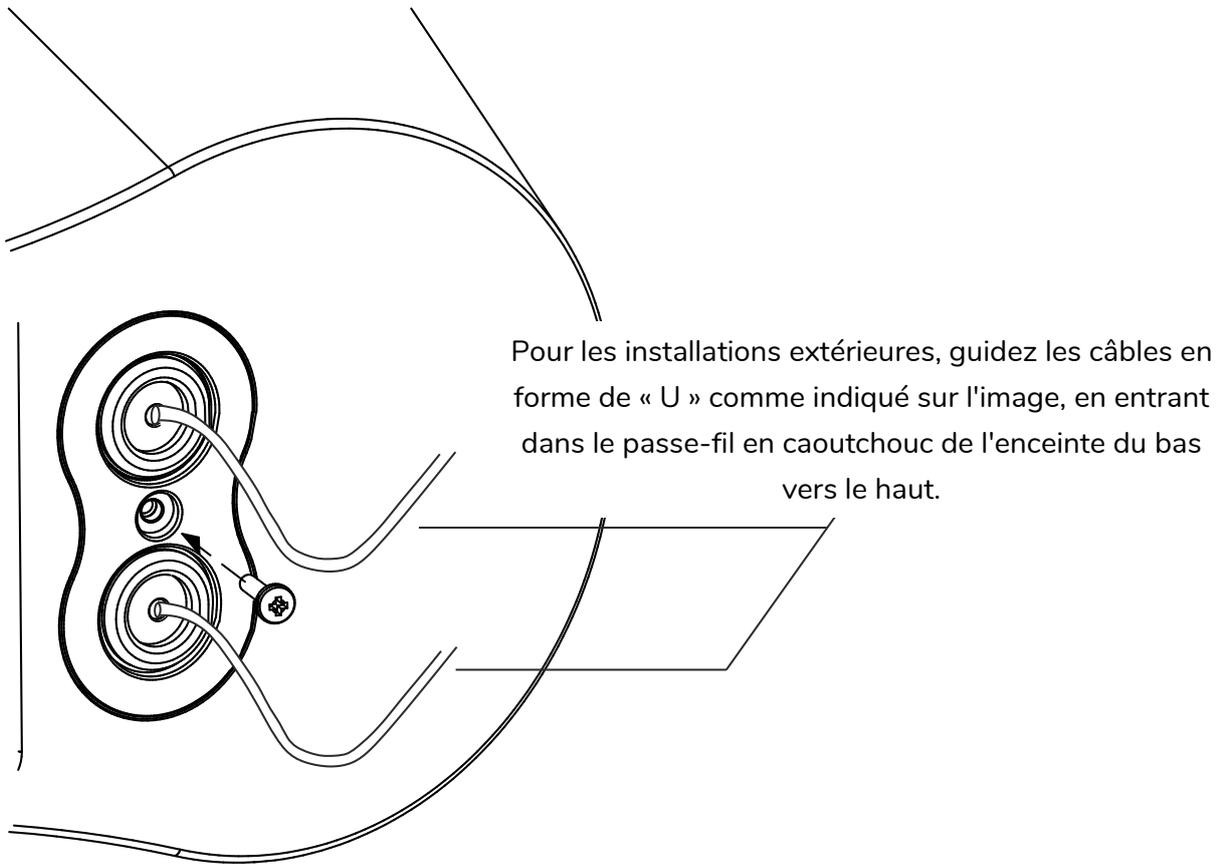
Pour les installations extérieures, utilisez un outil rond pour percer les passe-fils. Évitez les coupes droites. De plus, veuillez utiliser des câbles à profil rond plutôt que des câbles parallèles.
